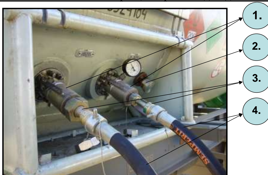
1 – Запорная арматура контейнера, 2 – Уровнемерное устройство, 3 – Переходные устройства налива, 4 – Заливные шланги.
